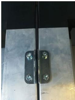
Serrez les vis union avec une clé Allen de 6 mm et une clé de 13 mm
