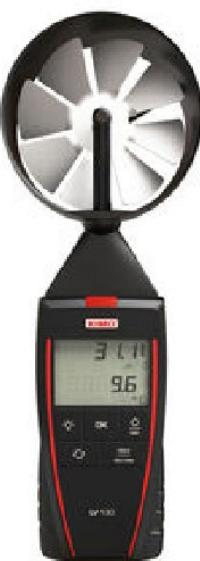
Les anémomètres à palettes sont des compteurs de vitesse ponctuels. Ils sont constitués d'une hélice supportée par une goupille, reliée à une bague de protection, sur laquelle la poignée est engagée. Pour effectuer la mesure, l'instrument est orienté de sorte que l'axe
