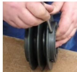
Mesurez que les rainures ont la même largeur. Resserrez les goujons de verrouillage
