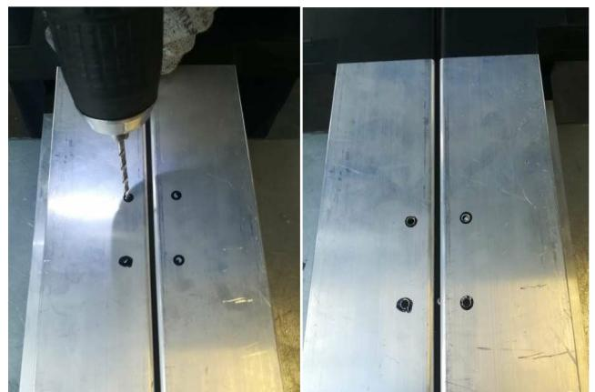
Fixez les 2 équerres avec les 4 vis autoperceuses AB 6,3x19 UNI 6950 ACZNCR à l'aide d'une clé à six pans creux de 10 mm.
