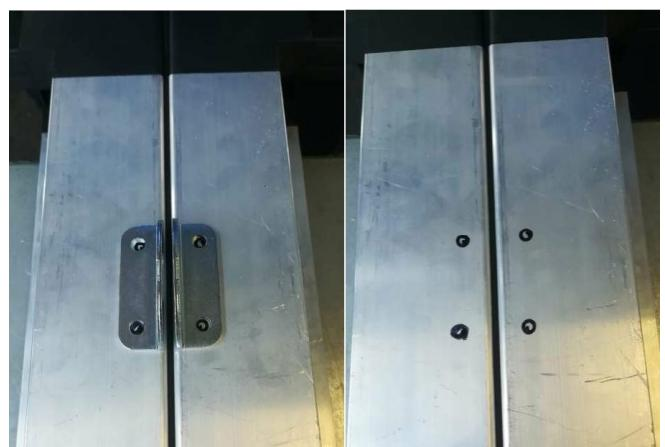
Percer des trous de 4 mm de diamètre
