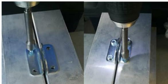
Serrer la vis centrale M8x20 UNI5931 8.8 ZNCR DIN 912 avec l'écrou hexagonale M8 GEO DIN 934-8 à l'aide d'une clé Allen de 6 mm et d'une clé de 13 mm.
