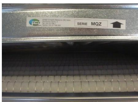
Vérifiez toujours les indications sur le cadre concernant le sens de montage. La flèche indique la direction du flux d'air.
