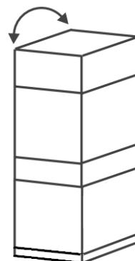
Approche des tronçons jusqu'à la distance de contact sans coups violents après avoir fixé le joint adhésif (fourni) sur tout le périmètre de contact (voir détails de fixation dans le chapitre suivant)
