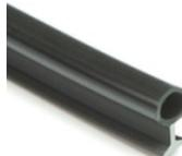
Dans le cas des profilés à rupture thermique, le joint ne peut pas être appliqué directement sur le profilé. Dans ce cas, il est collé sur le périmètre interne des panneaux. Le joint est une mousse mousse N12 à cellules fermées en EPDM. Résistance thermique continue - 40 ° C à + 75 ° C et résistance à la chaleur intermittente pendant de courtes périodes (+ 100 ° C). Densité: 60 kg / m<sup>3</sup> (ISO 845). Conductivité thermique à 40 ° C: 0,044 W / mK (ISO 2581)
