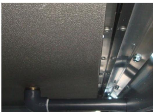
Si les barres de levage sont insérées à travers les trous de l'embase dans le sens indiqué dans l'exemple 1, le tuyau d'échappement empêche le passage de la barre (voir détail entouré en vert). Dans ces cas, le tuyau d'échappement peut être endommagé ou coupé par le passage de la barre. La direction correcte d'insertion des barres de levage est représentée par l'exemple 2.
