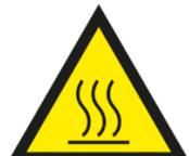
L'indication DANGER SURFACES CHAUDES est utilisée pour informer l'opérateur et le personnel assurant l'entretien de la présence de surfaces chaudes potentiellement dangereuses.
