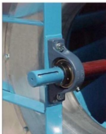
Roulement monté sur support non divisible
