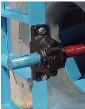
Roulement monté sur support
