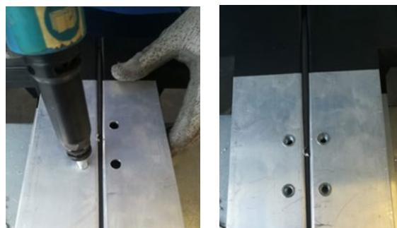
Fixez les 4 vis M6 avec une clé Allen de 5 mm
