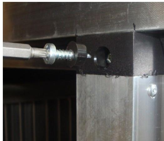
À la fin de cette opération, utilisez l'insert de tournevis spécial pour retirer les 2 vis de leur logement.
