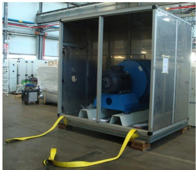
Utilisez toujours des barres d'élingue et interposez toujours des cales en bois ou en caoutchouc pour éviter que les courroies n'endommagent le module ou certaines parties de celui-ci pendant le levage.
