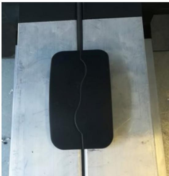
Ce type de joints peut également être utilisé à l'intérieur des différents modules pour joindre les 2 profilés de chant. Dans ce cas, les joints doivent être placés dans l'espace interne entre les 2 ailettes des profilés comme le montre l'image suivante.
