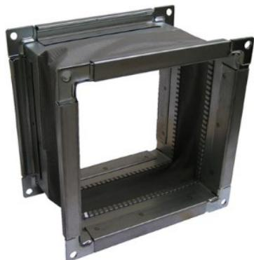
Le joint peut être monté directement sur des volets, sur des ouvertures de ventilation ou fixé directement sur des panneaux en correspondance avec des trous pour le passage de l'air. Le profil et l'angle sont en acier galvanisé et le tissu est en polyester enduit de PVC. La température maximale de fonctionnement est de 80 ° C. L'extension du joint en conditions de travail est de 140 mm. L'extension minimale est de 120 mm, l'extension maximale est de 160 mm.
