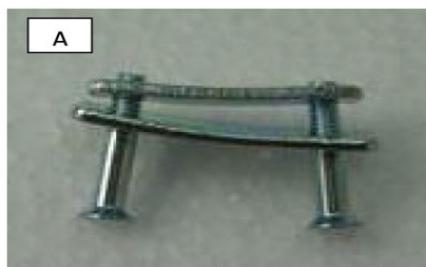
Pour remplacer la courroie, ouvrez la pince de connexion et retirez l'ancienne courroie. Insérez la nouvelle courroie autour du rotor et de la poulie en tirant fortement. Calculez ensuite la longueur requise de la nouvelle courroie. Fixez ensuite la pince reliant les 2 extrémités. Insérez ensuite la nouvelle courroie dans la poulie.
