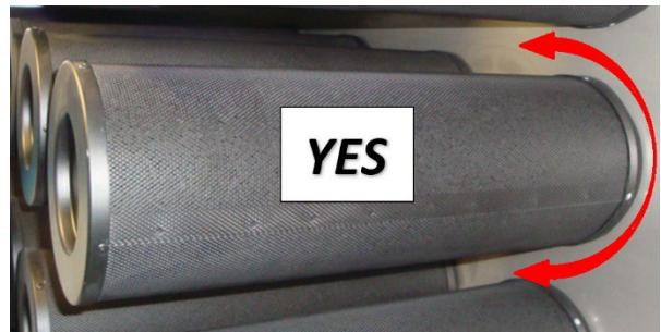
Rotation correcte à travers la base de support de la cartouche de filtre à charbon d'adsorption.
