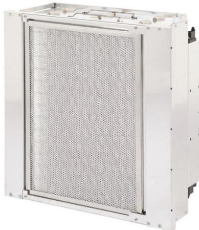
Un filtre électrostatique est un système de purification qui permet de séparer le flux d'air entrant des particules polluantes. Le système, par une différence de potentiel induite entre les électrodes d'émission et de collecte, sépare les particules contaminantes du gaz porteur qui est amené à s'écouler entre les électrodes.
