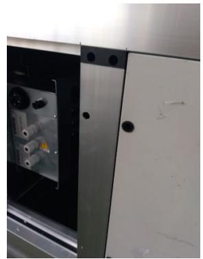
Insérez et fixez l'insert M6 (L210035 WURTH : 85ACITRM06C) avec l'outil d'insertion spécial.
