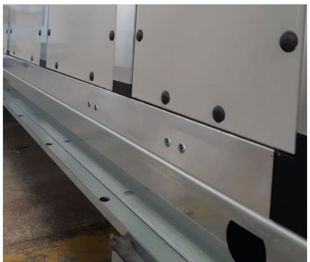
En particulier, il est nécessaire d'appliquer la poignée de retenue code 3022154 directement sur le profil de bord en aluminium, en insérant ensuite les boulons code L424072 SCREW TE M8x30 8.8 ZN UNI5739 avec les rondelles plates code L424031 ROND PIANA 8,4X24 FE GE3A-VL UNI6593.
