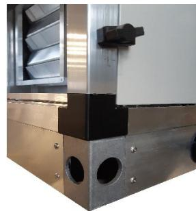
En plus d'être fixé le long du périmètre de la machine, le profil de la base est également utilisé comme renforcement dans les zones centrales dans un sens transversal pour donner une plus grande rigidité à la structure et pour garantir le déchargeement du poids des composants sur le sol.
