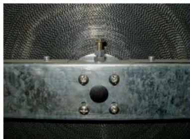
1 - Les deux vis de réglage sont au centre du rotor (photo A)
