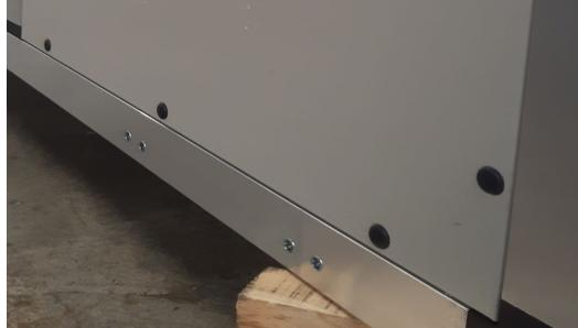
En particulier, il est nécessaire d'appliquer l'étrier en forme de L code 3022819 sur le profilé de bord en aluminium et de superposer la poignée de retenue code 3022154, en insérant ensuite les boulons code L424072 SCREW TE M8x30 8.8 ZN UNI5739 avec les rondelles plates code L424031 ROND PIANA 8.4X24 FE GE3A-VL UNI6593.
