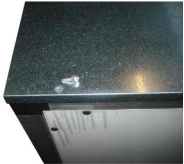
Le bord du toit le long du périmètre de la machine est toujours tourné vers le bas et adhère à la structure afin de prévenir les accidents et en tout cas de faciliter le détachement des gouttes d'eau. Le toit est fixé au profil de la centrale de traitement d'air au moyen de vis en acier inoxydable autoperceuses.
