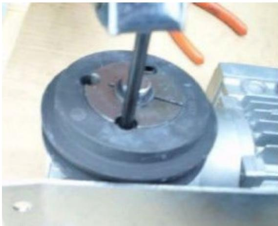
9 - Positionner le support moteur sur le châssis du récupérateur en rétablissant tous les verrous.
