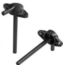
La prise de pression est utilisée pour connecter les instruments de détection de pression à l'intérieur des centrales de traitement d'air. Appliquée à travers le panneau ou la porte, il relie les tubes en caoutchouc normalement utilisés par les instruments de mesure. La forme à 90 ° permet au tube externe de rester adjacent au panneau en évitant d'éventuels obstacles ou déconnexions accidentelles. Il est fait de nylon avec fibre de verre (PA6 FV20%).
